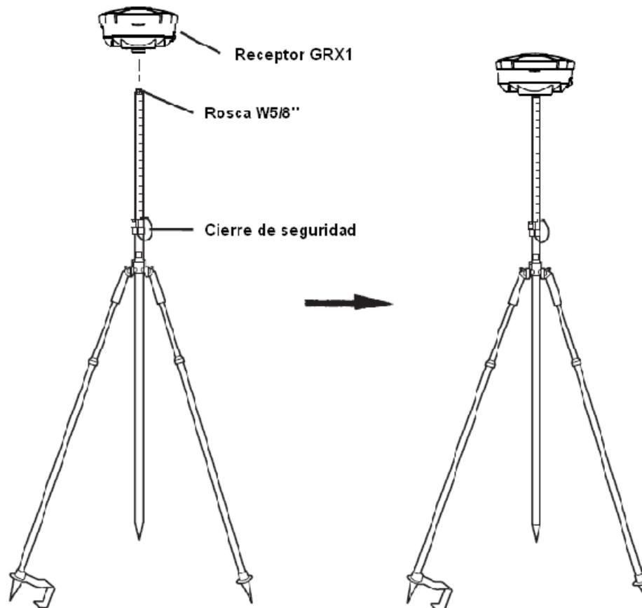
**Fig. 4.2 Montaje del receptor Movil**
