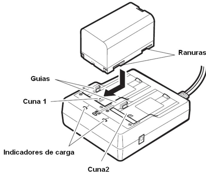
Fig. 1-3 Colocacion de la bateria en el cargador
