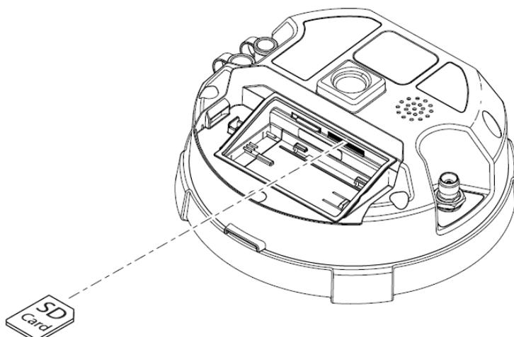
Fig. 2-2 Instalacion de la tarjeta SD/SDHC
