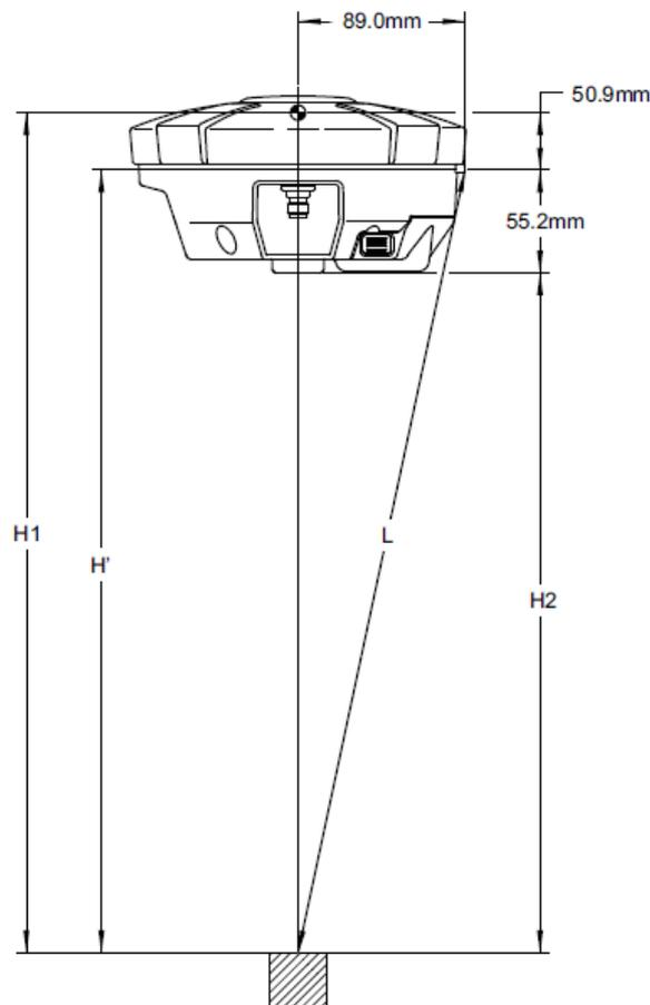
**Fig. 4-3 Desfases en la antena del GRX1**
