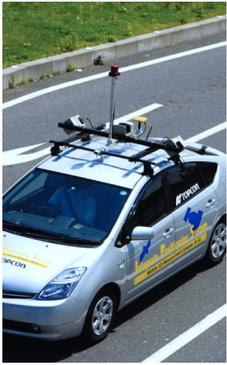
El sistema IP-S2 estándar incluye tres escáner LiDAR de alta resolución que cubren la trayectoria del vehículo a nivel del terreno y barren las áreas adyacentes a una distancia de 30 metros.
